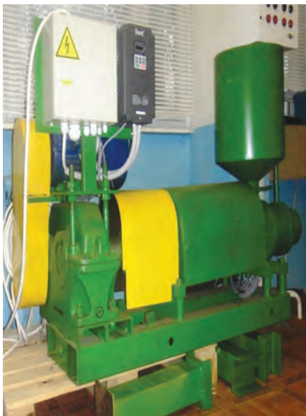
Пілотна установка для отримання біодизеля
