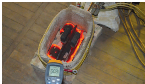
Нагрів чавунного гальмівного башмака редуктора вагона метро
