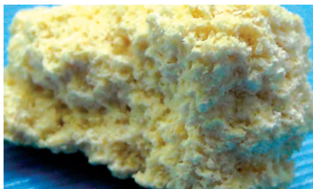
Гель на основі хітозану з наночастинками срібла
