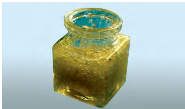
Пористий композит на основі хітозану та фосфатів кальцію для остеопластики
