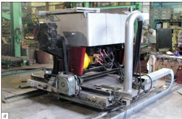
Магнітодинамічні міксери-дозатори для алюмінієвих сплавів (а), для чавуну і сталі (б)
