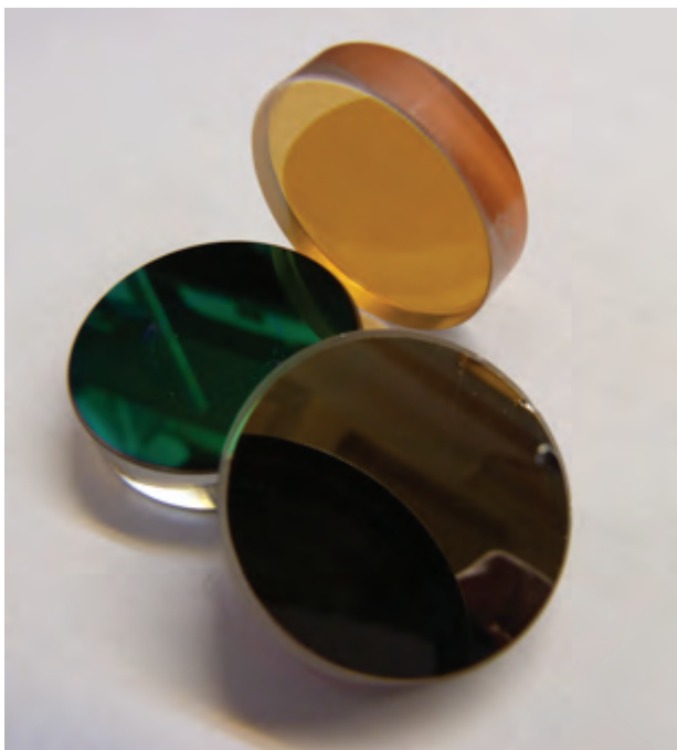
Зразки покриттів на кварцових підкладках, отримані з матеріалів систем: Ge — ZnS (коричневий колір); Ge — ZnO (помаранчевий колір); високочистий ZnS / Si (зелено-блакитний колір)
