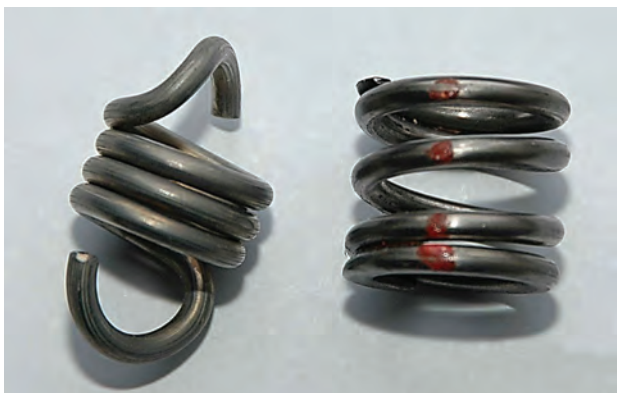
Високоміцні титанові пружини для аерокосмічного застосування
