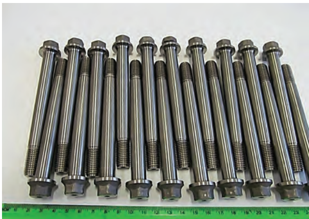
Високоміцні титанові кріплення для аерокосмічного застосування
