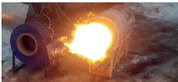
Спалювання виробленого композиційного палива за допомогою пальникового пристрою
