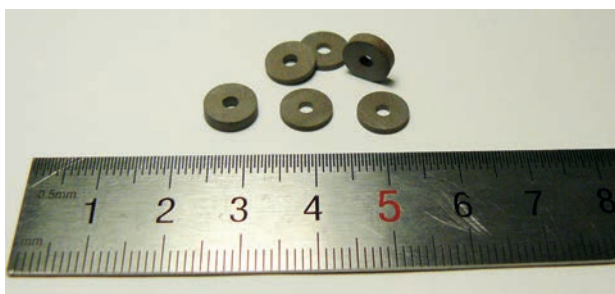
Заготовки дискових блокувальних НВЧ конденсаторів
