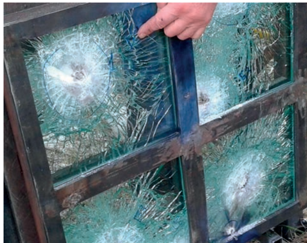
Система укріплення вікон споруд базовими прозорими блоками класу СК 6 після випробувань
