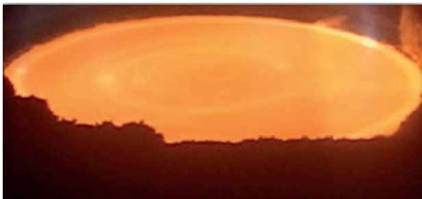
Зображення кристалізатора d = 650 мм, перепплав титану
