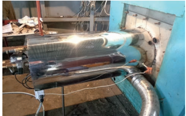
Пальниковий пристрій для спалювання композиційного палива на паровому котлі
