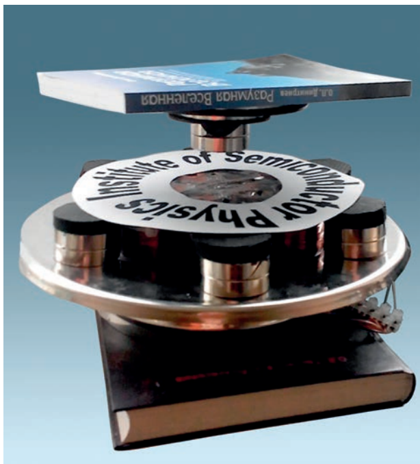
Зовнішній вигляд приладу для утримання та переміщення предметів над поверхнею
