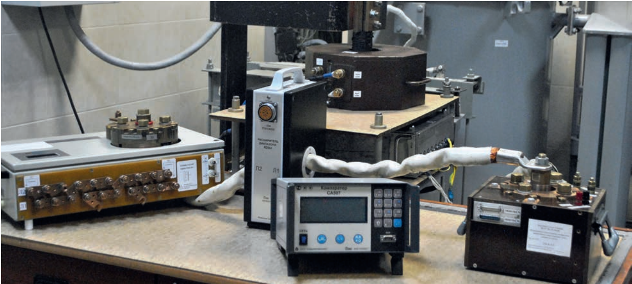
Загальний вигляд багатозначної міри: міра С – ліворуч, міра А – у центрі, міра В – праворуч
