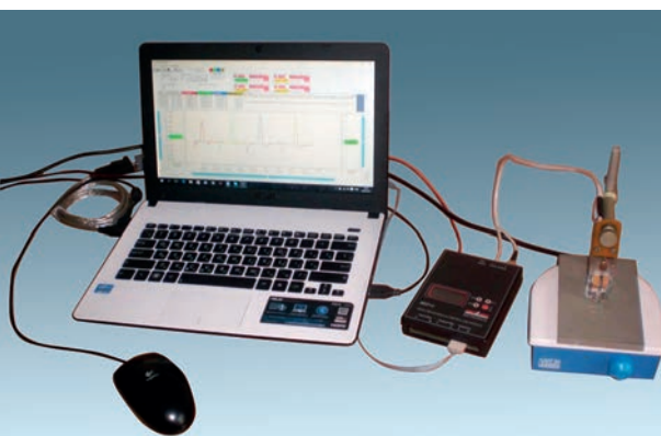
Загальний вигляд кондуктометричної біосенсорної системи
