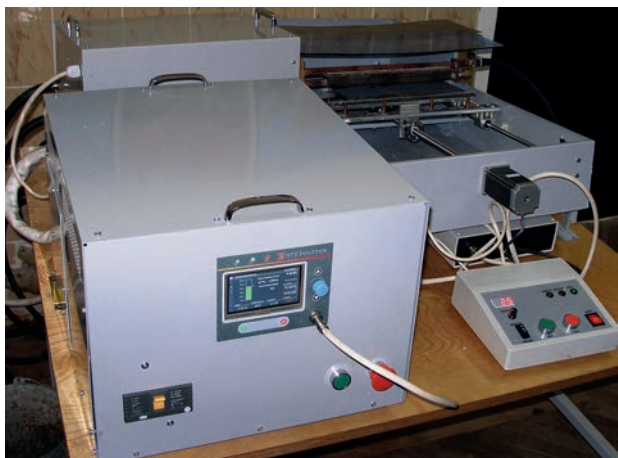
Установка для поверхневого загартування титанових плит потужністю 80 кВт
