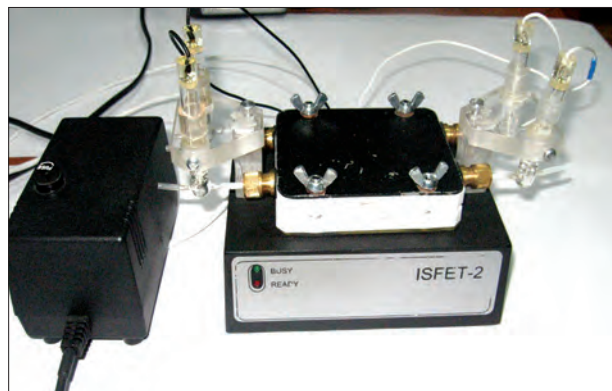
Вимірювальна установка з мультибіосенсором і проточною системою
