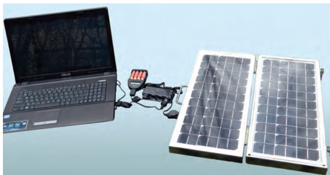
Мобільна фотоелектрична станція в робочому та складеному вигляді
