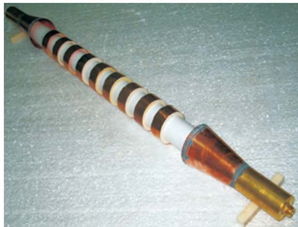
Дифракційна омні-антена для систем мобільного зв'язку
