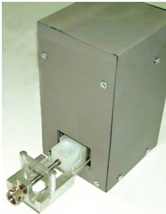
Оптоелектронний колориметричний течешукач летких газів «КД-3» разом з переносним блоком сенсора-маяка
