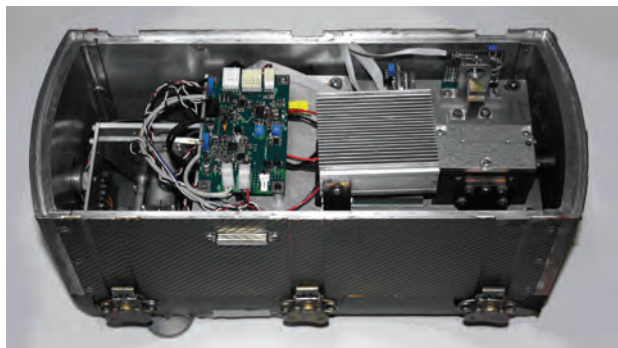
Вертикальний сейсмометр із цифровим лазерним інтерферометром
