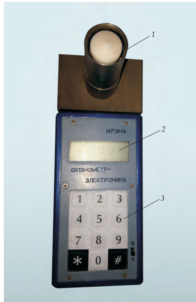
Портативний аналізатор «ИРЭНА»: 1 – вимірювальний датчик; 2 – індикатор; 3 – панель керування
