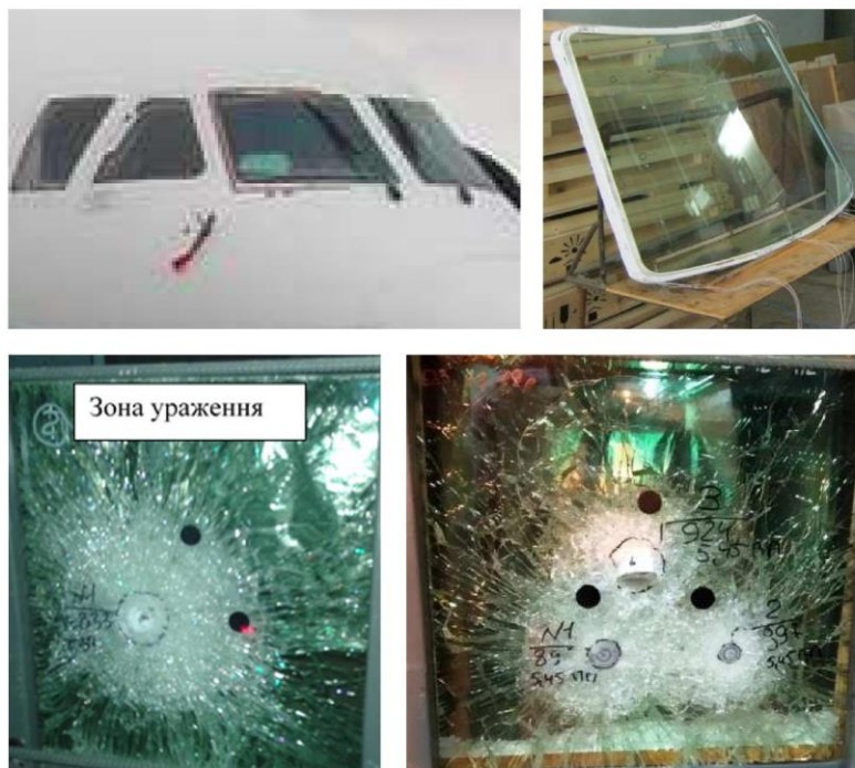
Зменшено пошкодження і втрату оптики блоків Забезпечено кулеустійкість та ресурс бронескла
