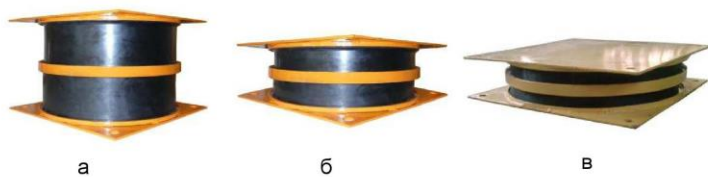
Експериментальні зразки конструкцій а – сейсмозахисний блок 1-го типу (2×120 мм, діаметр 400 мм); б – сейсмозахисний блок 2-го типу (2×70 мм, діаметр 400 мм); в – сейсмозахисний блок 3-го типу (2×50 мм, діаметром 480 мм і 500 мм)
