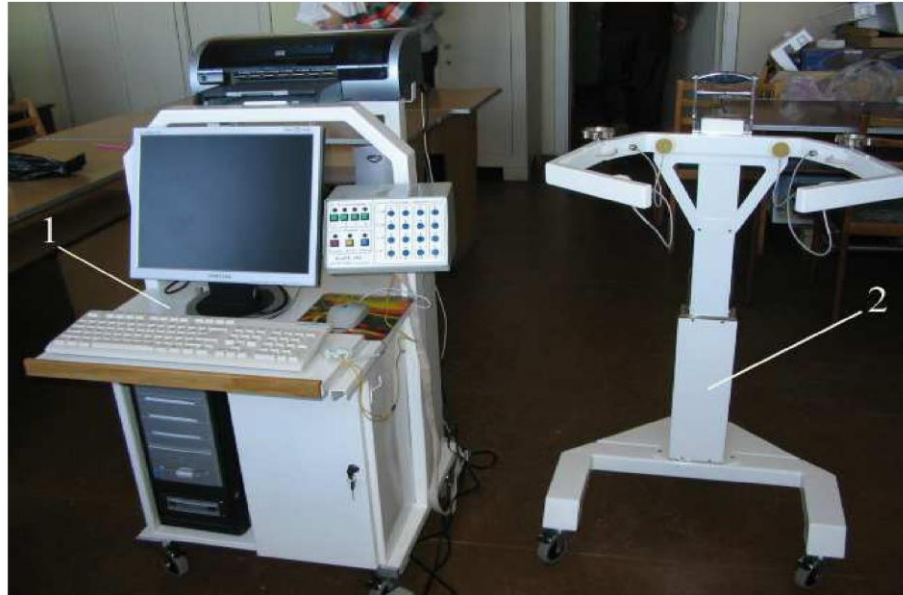
Загальний вигляд фоноспірографічного комплексу "КоРА-03М1" 1 – робоче місце оператора; 2 – технологічна стійка
