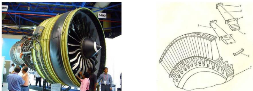
Сучасний авіаційний газотурбінний двигун і робоче колесо турбіни з попарно бандажованими лопатками
