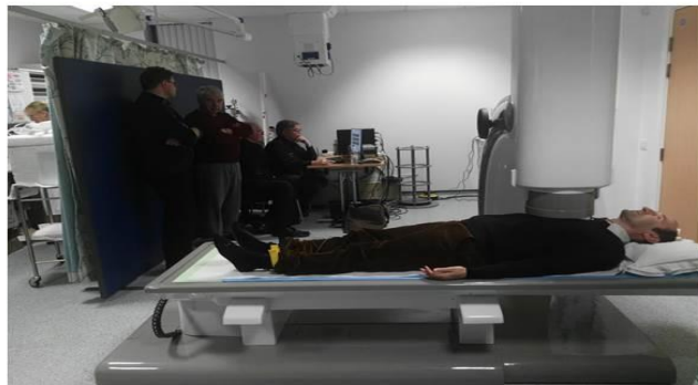
SQUID- сенсорний кардіомагнітний сканер, створений в Інституті кібернетики ім. В.М. Глушкова НАН України, встановлено в госпіталі імені Джона Редкліффа (John Radcliffe Hospital), Велика Британія
