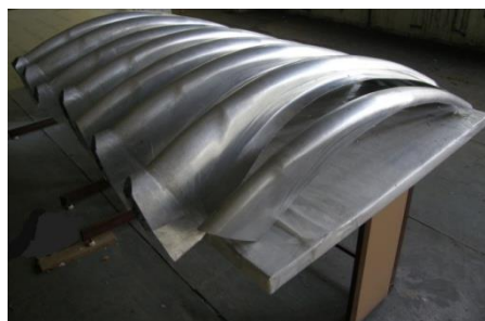
Деталі обшивки крила літака, виготовленні із міцного сплаву 2024-T4 за технологією ЕГ штампування і калібрування
