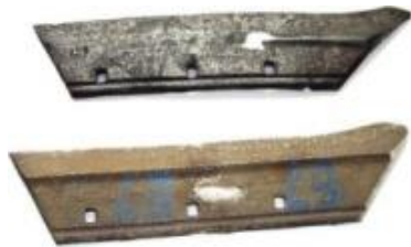
ПОРІВНЯЛЬНІ ВИПРОБОВУВАННЯ ЗРАЗКІВ З СТАЛІ 65Г ТА З БЕЙНІТНОГО ЧАВУНУ В СУХОМУ ПІСКУ (ПЕРШІ СТОВПЧИКИ) ТА ГЛИНИСТІЙ І ПІСЧАНИЙ ВОЛОГИЙ ҐРУНТ
