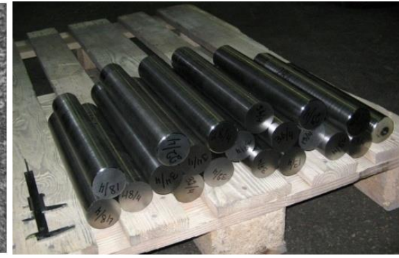
Пресовані прутки Ø60 мм з титанового сплаву VT22
