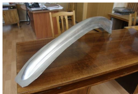
Деталі обшивки крила літака, виготовленні із міцного сплаву 2024-T4 за технологією ЕГ штампування і калібрування
