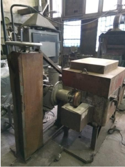
1 - піч опору, 2 - диспергатор, 3 - тигель, 4 - кришка печі опору, 5 - «кишень», 6 - диск-кристалізатор, 7 - привід вертикального переміщення диска - кристалізатора, 8 - привід обертання
