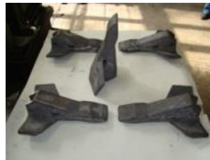
ПОРІВНЯЛЬНІ ВИПРОБОВУВАННЯ ЗРАЗКІВ З СТАЛІ 65Г ТА З БЕЙНІТНОГО ЧАВУНУ В СУХОМУ ПІСКУ (ПЕРШІ СТОВПЧИКИ) ТА ГЛИНИСТІЙ І ПІСЧАНИЙ ВОЛОГИЙ ҐРУНТ
