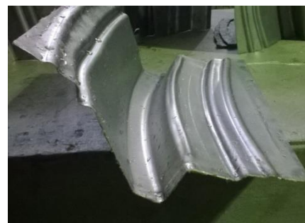
Фрагмент автомобільної деталі із сталі Fortiform 1050, яка калібрувалась на ЕГ пресі
