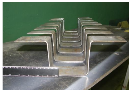
Тестові деталі з високоміцної сталі CP800 до та після ЕГ калібрування
