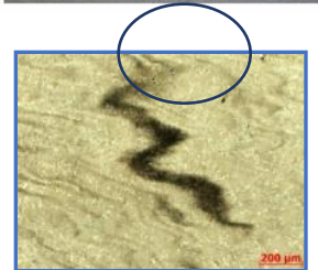
Макро- і мікроструктура маточини залізничного колеса Ø 957 мм, сталь марки 2
