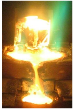
Процес плавки та зливков Прокат сплаву VT19 Ø110 мм сплаву VT19
