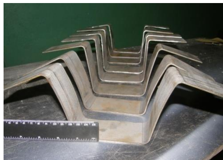
Тестові деталі з високоміцної сталі CP800 до та після ЕГ калібрування
