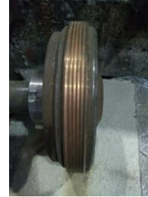
1 - диск - кристалізатор, 2 - рідкий метал
