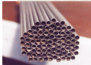
Трубні заготовки для тепловідільних елементів зі сплаву Zr1Nb
