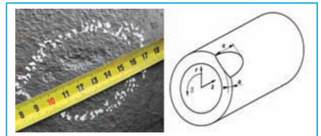
Зовнішній вигляд та схема дефекту локальної корозійної втрати металу ділянки трубопроводу
