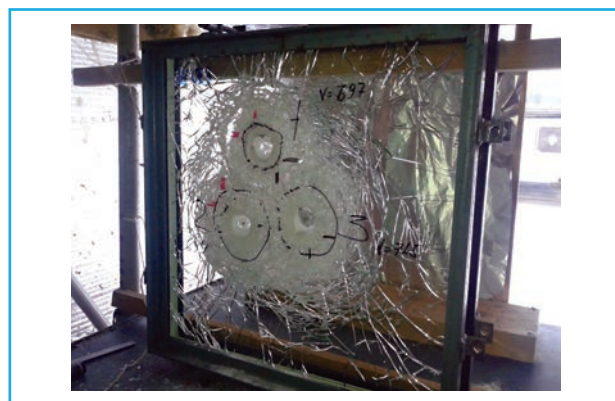
Броньований блок для балістичного захисту після позитивних балістичних випробувань за класом СК 3 ДСТУ 4546:2006
