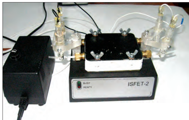
Вимірювальна установка з мультибіосенсором і проточною системою
