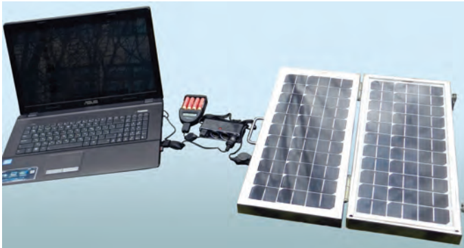
Мобільна фотоелектрична станція в робочому та складеному вигляді
