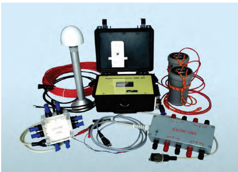
Блок електроніки магнітотелуричної станції ЛЕМІ-424 у комплекті з електродами та польовим устаткуванням
