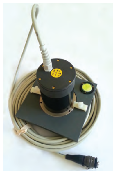
3-компонентний ферозондовий магнітометр магнітотелуричної станції ЛЕМІ-424
