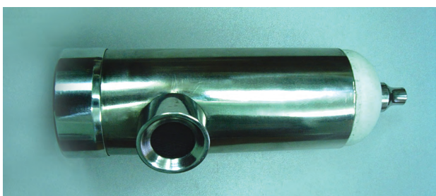
Оптичний криостат з германієвим вікном для охолоджуваних InAs та InSb фотодіодів
