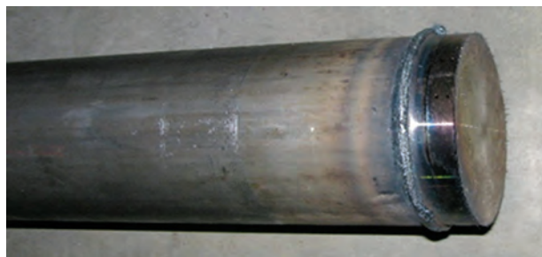
Корпус гідроциліндра, \varnothing 110 \times 7,5 мм
