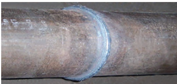
Зварне з'єднання, труба \varnothing 120 \times 7 мм
