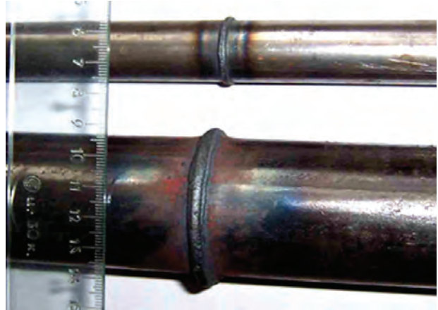
Зварні з'єднання труб, \varnothing 25 \times 2 мм та \varnothing 42 \times 4 мм
