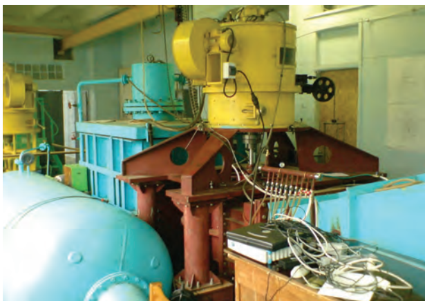
Модельний блок поворотно-лопатевої гідротурбіни ПЛ30, який встановлено на енергокавітаційному стенді ЕКС-15
