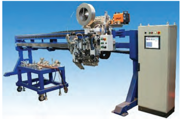
Установка для аргонодугового зварювання титану у вузький зазор магнітокерованою дугою
