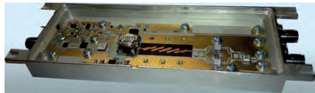
Перетворювач частоти вгору Ku-діапазону довжин хвиль
