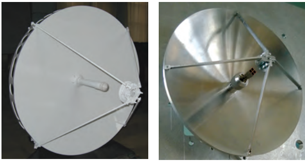
Антенa Кассегрена Ka-діапазону (діаметр 1 м, 49 дБі, 0,6 \times 0,6^\circ , РБП<-18, 2 поляризації) (ліворуч). Антенa Кассегрена W-діапазону (діаметр 0,2 м, 40 дБі, 1 \times 1^\circ , моноімпульс) (праворуч)
