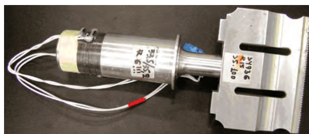
Ультразвуковий випромінювач з плоским концентратором для зварювання подовжніх швів
