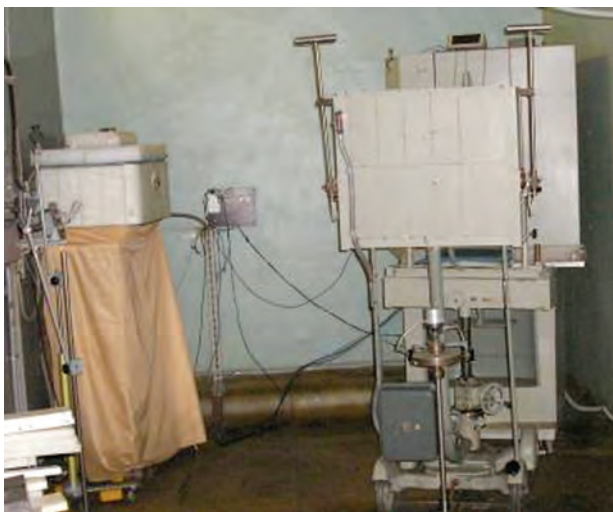
Спеціальний терапевтичний бокс для проведення сеансів нейтронного опромінення
