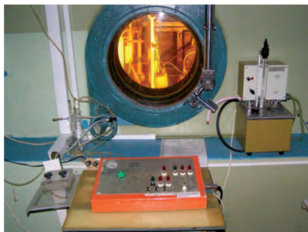
Гаряча камера стаціонарного екстракційного генератора 99mTc
