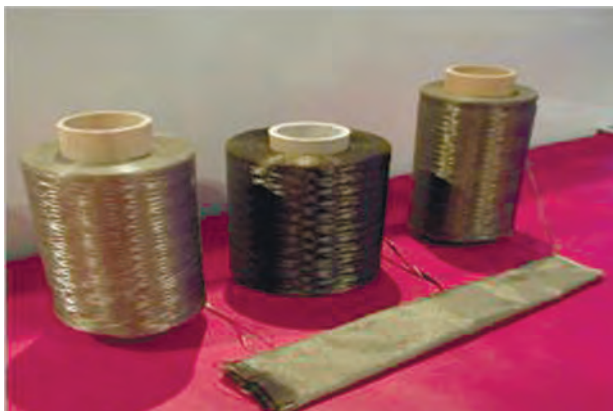
Зразки неперервних базальтових волокон і тканина на їх основі
