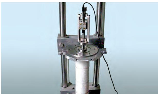
Кварцовий дилатометр, у конструкції якого використано розроблений зміцнений інварний сплав
