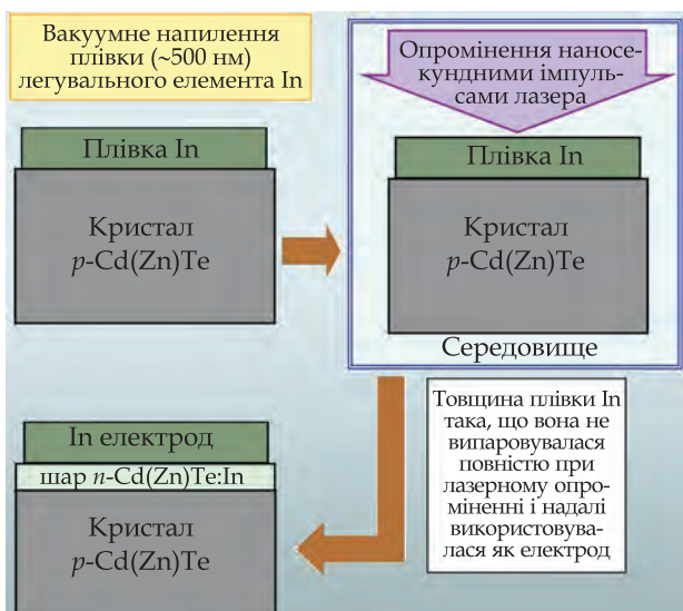
Схема технологічних процесів лазерно-індукованого твердофазного легування наночастинок кристала p\text{-Cd(Zn)Te} домішкою In та формування p\text{-}n -переходу
