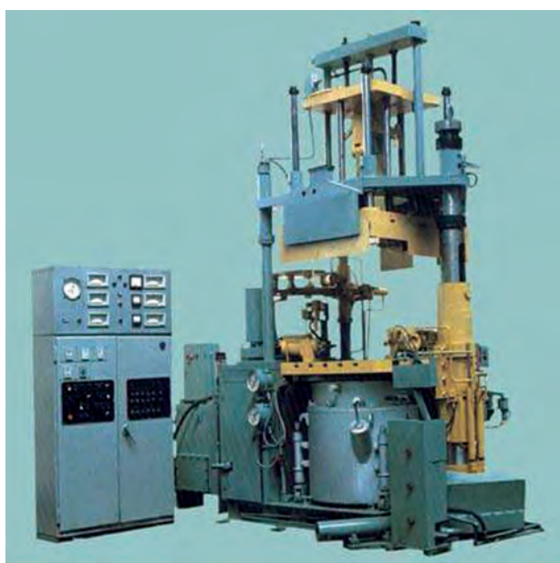
Машина лиття під низьким регульованим тиском АЛУГ-3
