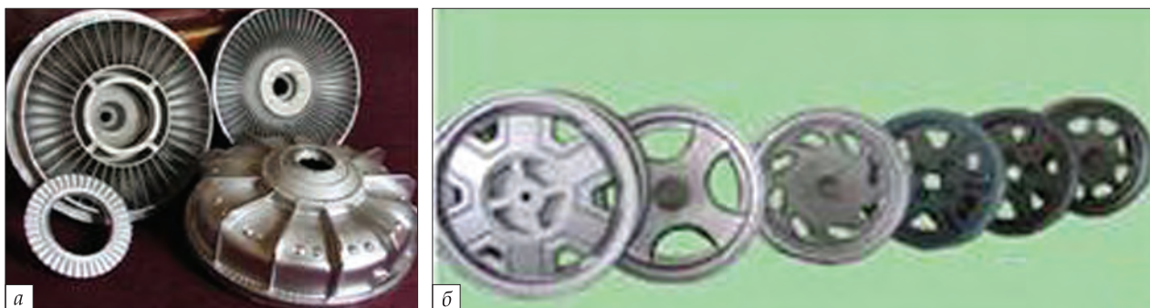
Комплект деталей гідромуфти (а) та колеса легкових автомобілів (б), отримані литтям під низьким тиском на машині АЛУГ-3
