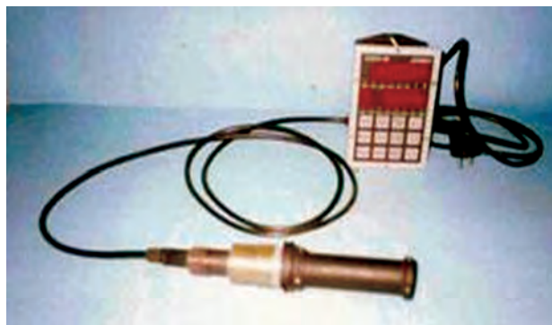
Установка типу УТЕКС-Ч для термодинамічного експрес-контролю форми графіту в чавуні
