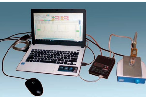
Загальний вигляд кондуктометричної біосенсорної системи
