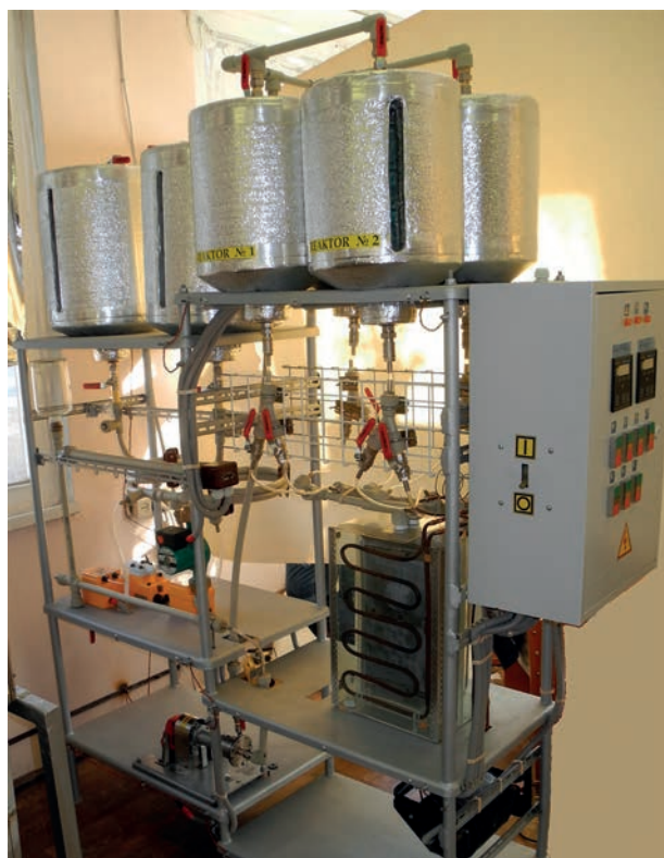
Експериментальна установка для виготовлення дизельного біопалива
