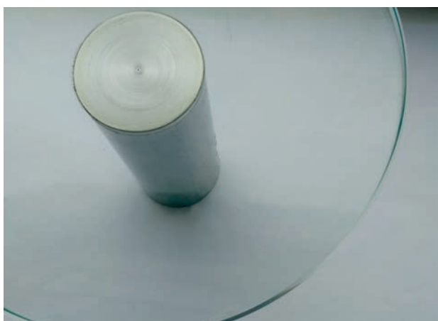
Склеювання металевих і скляних поверхонь
