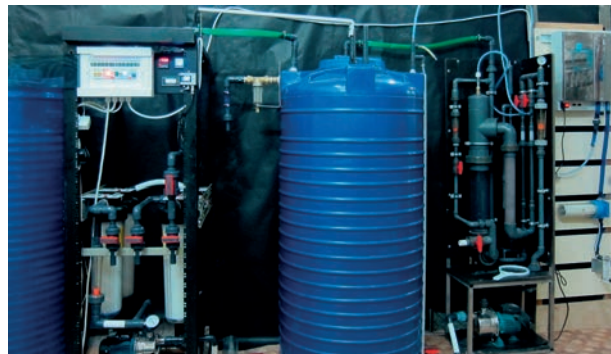
Мобільна системи очищення води озонуванням
