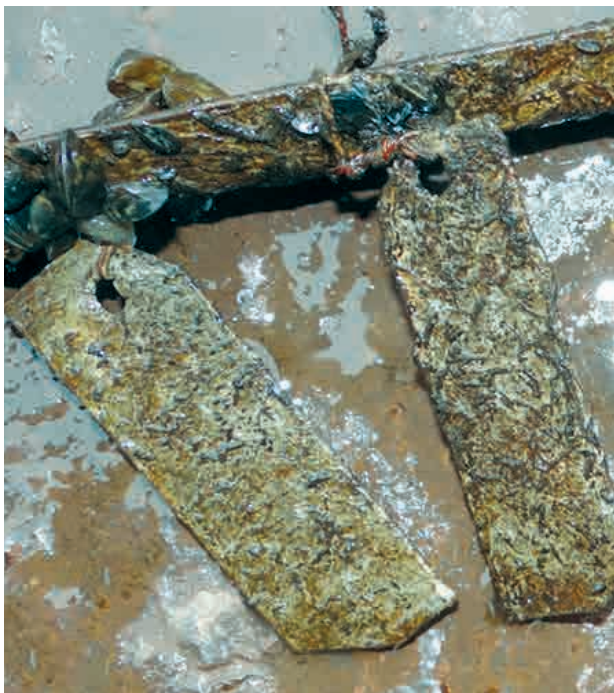
Пофарбовані сталеві пластини після витримування впродовж 228 діб у річці Дніпро: контрольні покриття на основі корабельної фарби вгорі і покриття, які містять 10 % полімерного біоциду
