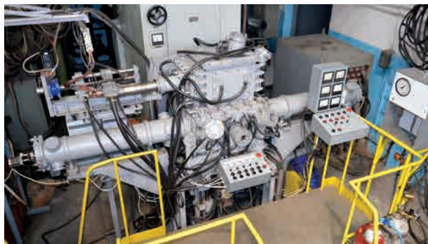
Плазмово-індукційна установка для вирощування монокристалів тугоплавких металів
