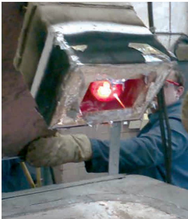
Реакційна камера з плазмотроном у режимі холостого ходу для обробки алюмінієвих сплавів
