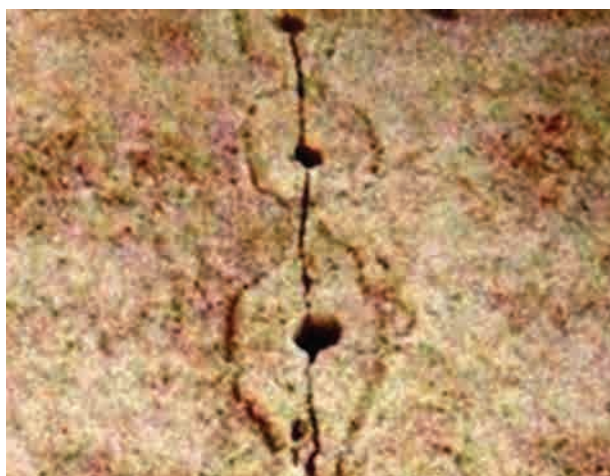
Зовнішній вигляд розколотого вибухом блока
