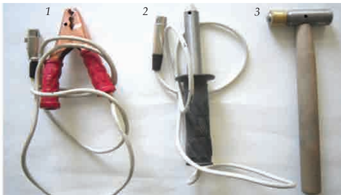
Апаратура КВАК-4 та її комплект: 1 — накидний датчик для реєстрації вібрації анкера; 2 — контактний датчик для реєстрації вібрації довільних конструкцій; 3 — збудник коливань
