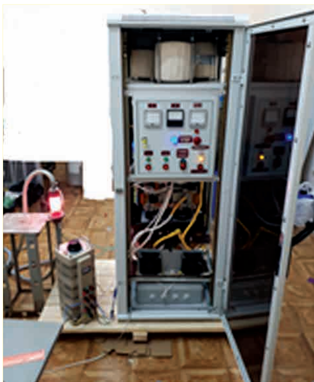
Плазмохімічна установка глибокої утилізації рідких радіоактивних відходів
