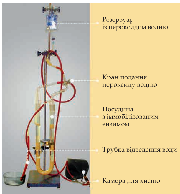
Портативний енергонезалежний генератор кисню на основі U-подібної колонки
