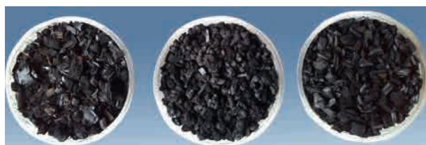
Зразки карбонізованих органічних відходів
