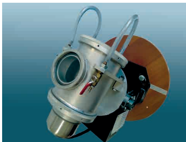
Реактор установки очищення рідких радіоактивних відходів на основі синтезу нанокмполітів
