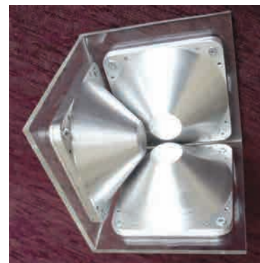
Двигун-маховик із вбудованою системою керування (ліворуч), двигун-маховик для тривісної системи орієнтації з виносною системою керування, тривісна система орієнтації супутника (праворуч)
