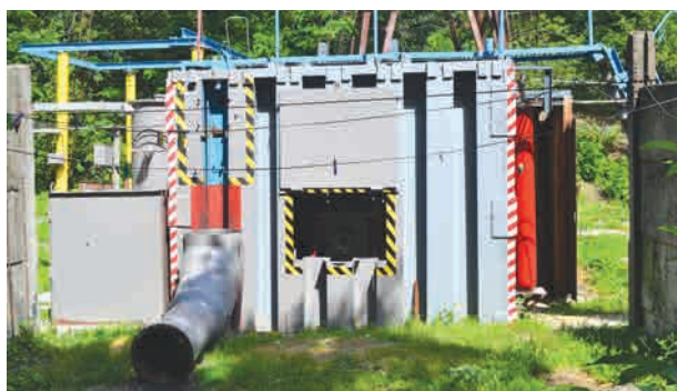
Стенд вогневих випробувань детонаційних ракетних двигунів
