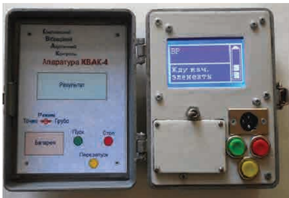
Апаратура КВАК-4 та її комплект: 1 — накидний датчик для реєстрації вібрації анкера; 2 — контактний датчик для реєстрації вібрації довільних конструкцій; 3 — збудник коливань
