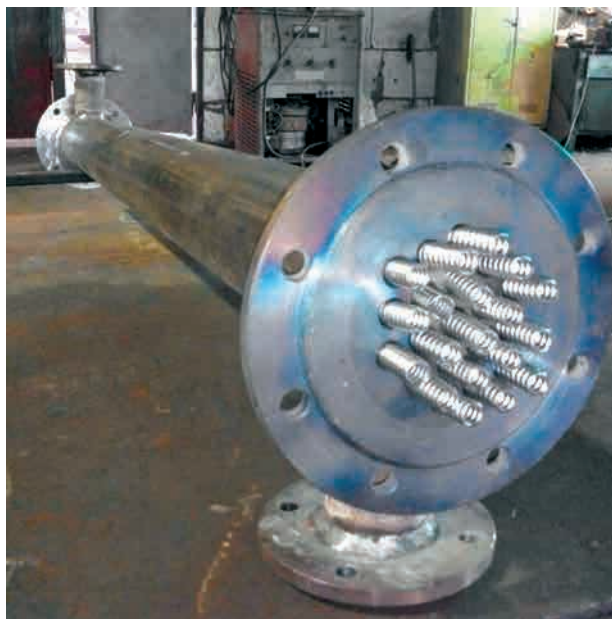
Трубчастий теплообмінник нового покоління на профільованих трубах
