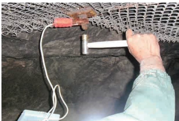
Контроль міцності закріплення анкера в шахтних умовах
