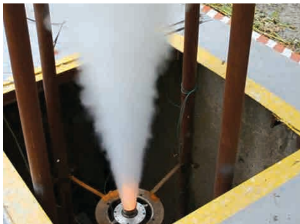
Стенд дослідження монопалива для детонаційних пристроїв та для вогневих випробувань твердопаливних ракетних двигунів
