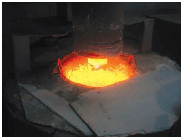
Заглиблення плазмової дуги у розплав для обробки рафінуванням
