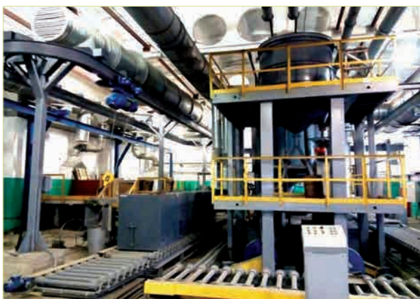
Автоматизований комплекс для реалізації технології лиття за моделями, що газифікуються, потужністю 3000 тонн/рік
