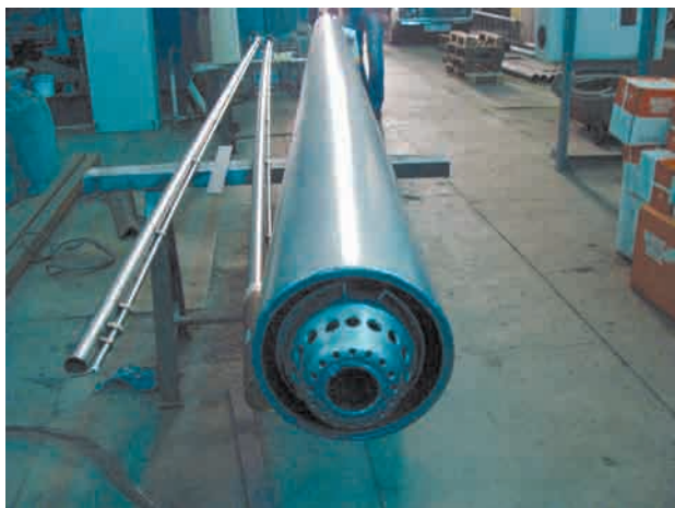
Пальник з регульованими параметрами факела
