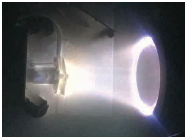
Фокусоване джерело енергетичних газових іонів ПАШ125
