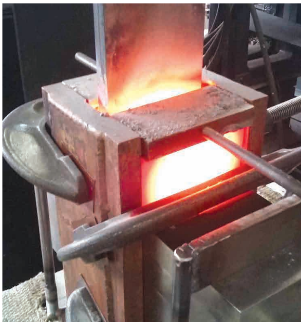
Процес зварювання титанових плит
