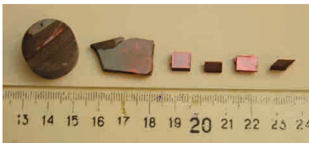
Монокристали \text{TlGaSe}_2 та виготовлені орієнтовані зразки з площинами, перпендикулярними до різних кристалографічних напрямів
