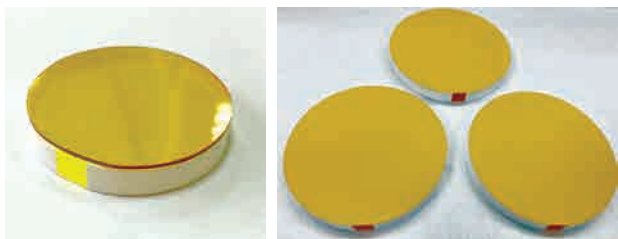
Альфа-бета-детектор, що працює у спектрометричному режимі (ліворуч), альфа- та альфа-бета-детектори, що працюють у лічильному режимі (праворуч)
