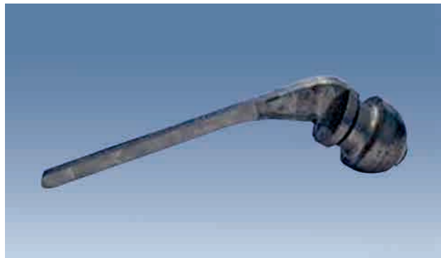
Виливки з титану та цирконію, виготовлені за допомогою електронно-променевої технології
