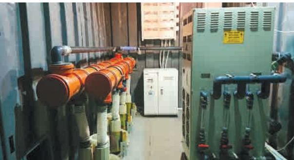
Система озонування сільськогосподарської дисперсної продукції на базі озонатора Stream Ozone OzW50 (до 100 г/год)
