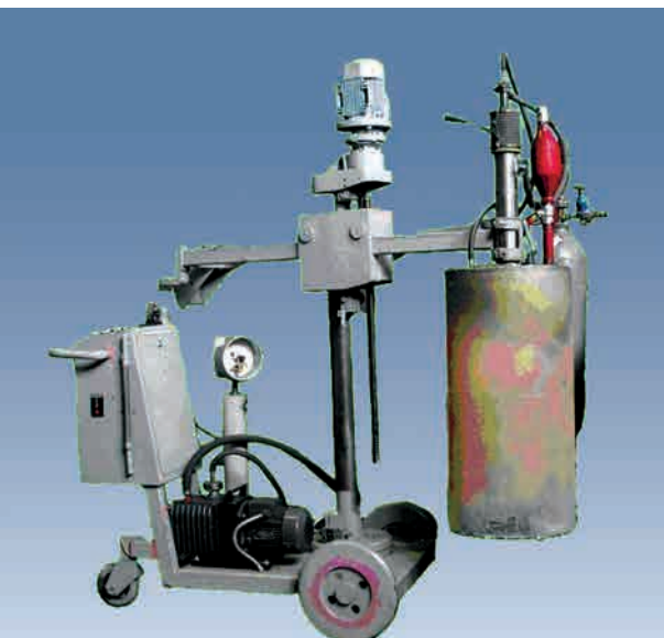
Вакуумно-плазмова установка для рафінування сплавів
