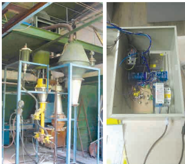
Струминний млин з системою керування (ліворуч), блок управління завантаженням млина (праворуч)
