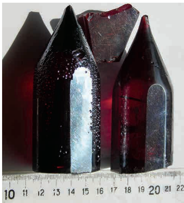
Монокристали пруститу \text{Ag}_3\text{AsS}_3
