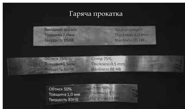
Зразки смуги з механічними характеристиками, одержані двовалковим розливанням та після подальшої гарячої прокатки
