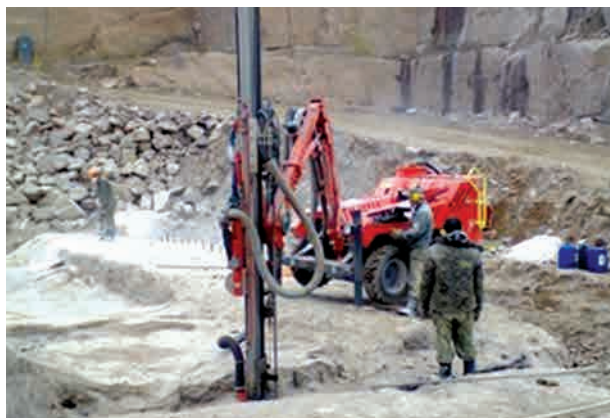
Технологія відділення скельної породи від масиву: буріння шпурів у блоці
