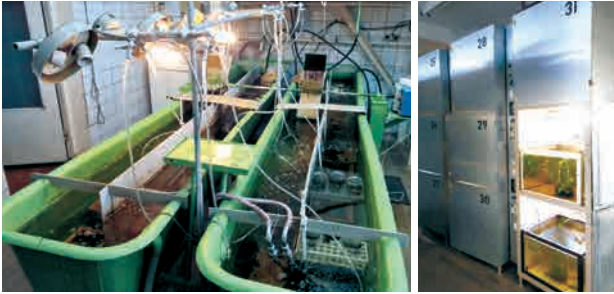
Штучні гідроекосистеми (мікрокосми) та камери з регульованими параметрами водного середовища
