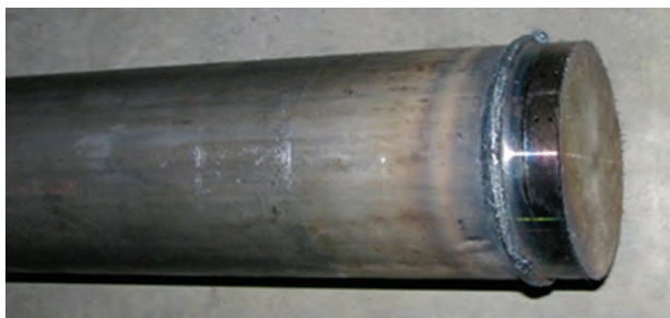
Корпус гідроциліндра, \varnothing 110 \times 7,5 мм
