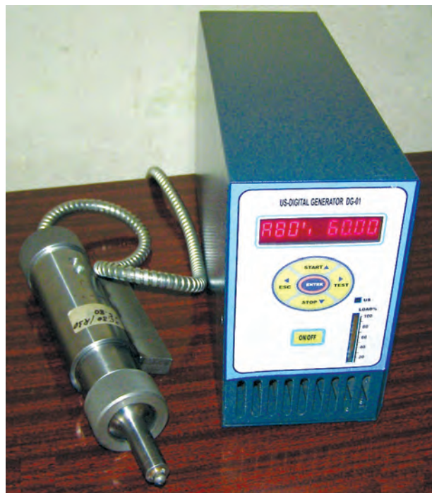
Обладнання для УЗФО (інструмент з твердосплавним наконечником, УЗ-генератор)
