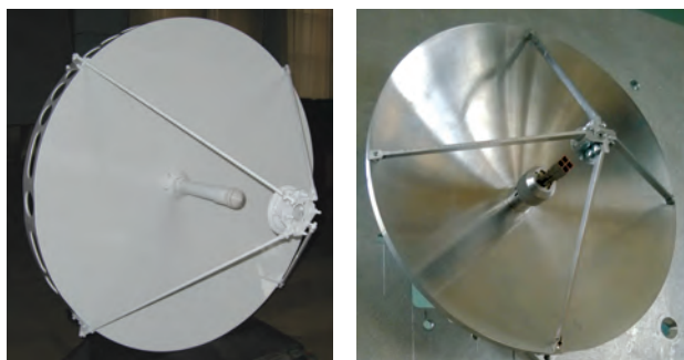
Антенна Кассегрена Ka-діапазону (діаметр 1 м, 49 дБі, 0,6 \times 0,6^\circ , РБП<-18, 2 поляризації) (ліворуч). Антенна Кассегрена W-діапазону (діаметр 0,2 м, 40 дБі, 1 \times 1^\circ , моноімпульс) (праворуч)
