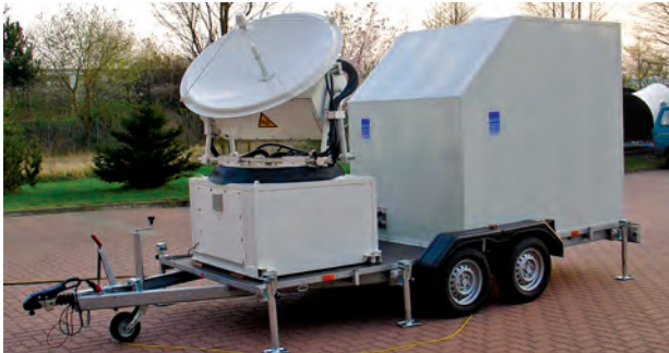
Метеорадар зі сканувальною антеною
