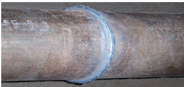
Зварне з'єднання, труба \varnothing 120 \times 7 мм
