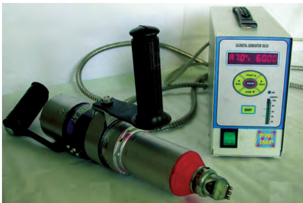
Обладнання для УЗУО металевих виробів (ударний інструмент та УЗГ)
