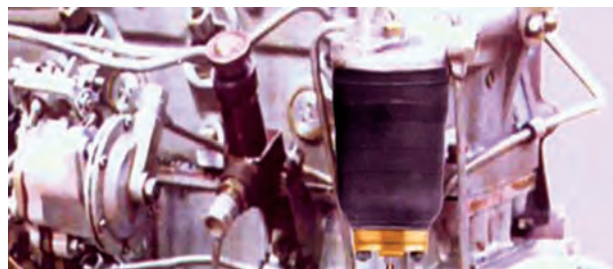
Паливний фільтр, який підігрівають
