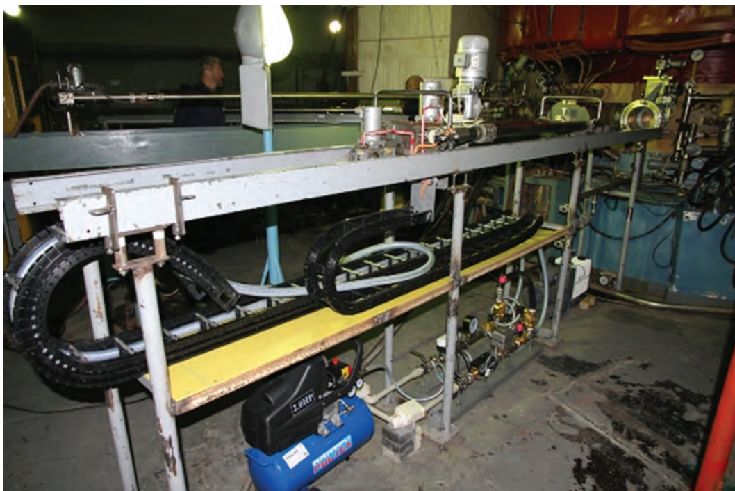
Автоматизована установка для виробництва радіонукліда ^{82}\text{Sr}
