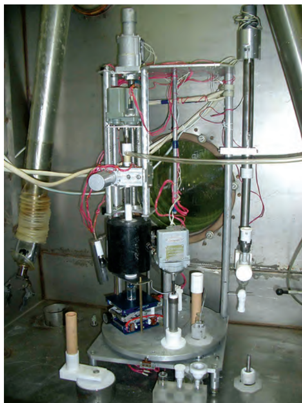
Установка для виробництва капсул натрію йодиду ( ^{131}\text{I} )
