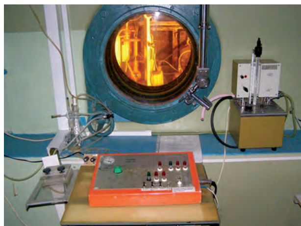
Гаряча камера стаціонарного екстракційного генератора 99mTc
