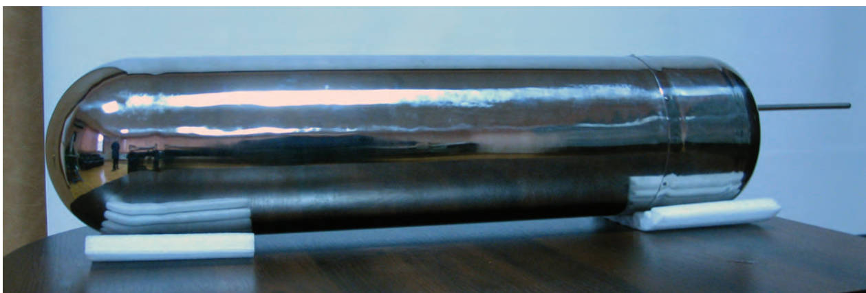
Портативне джерело швидких нейтронів (діючий прототип)
