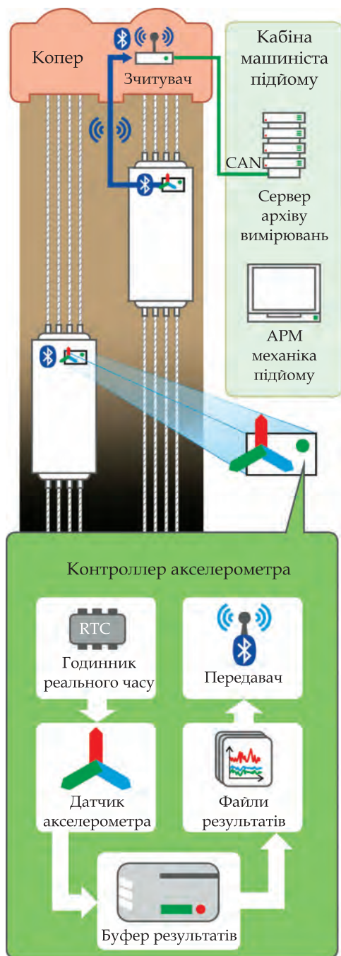
Схема технології безперервного контролю горизонтальної плавності руху шахтних підйомних посудин у вертикальних стовбурах із жорстким армуванням
