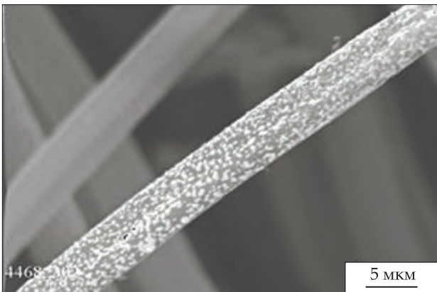
Імобілізація на поверхні вуглецевого волокна наночастинок міді
