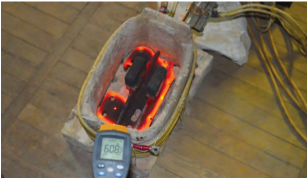
Нагрів чавунного гальмівного башмака редуктора вагона метро
