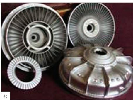
Комплект деталей гідромуфти (а) та колеса легкових автомобілів (б), отримані литтям під низьким тиском на машині АЛУГ-3
