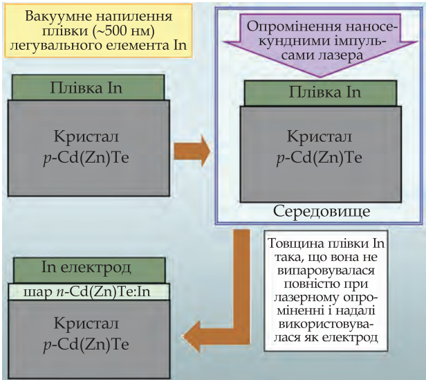
Схема технологічних процесів лазерно-індукованого твердофазного легування наночару кристала p -Cd(Zn)Te домішкою In та формування p-n -переходу
