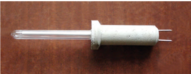
Термоелектричний змінний перетворювач занурення типу ТЗП-Ш
