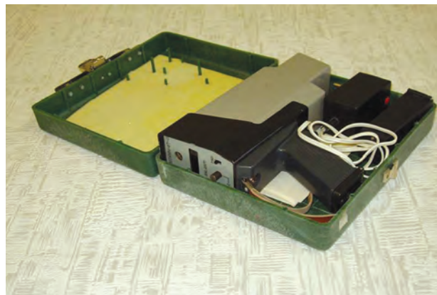
Одноколірний безконтактний переносний термометр типу ТПЦ-Б
